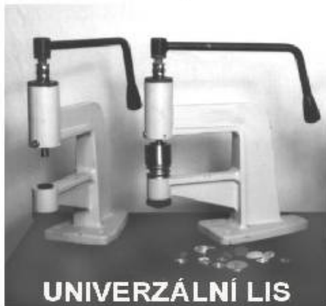
RBL - 27 RUČNÍ VŘETENOVÝ LIS - ŠROUBOVICE S OCELOVÝMI KULIČKAMI
